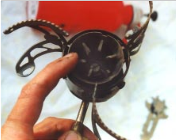
Der Clou: Kein Generator, sondern Heizrippen bringen den Brenner auf betriebstemperatur.
